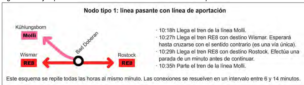
Figura D27: ejemplo de funcionamiento de una estación nodal de tipo 1.
