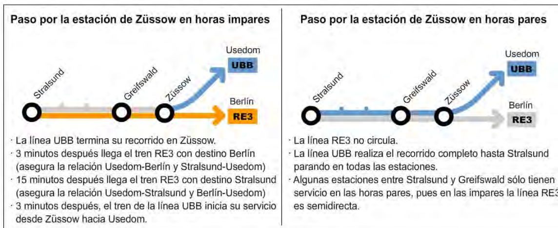
Figura D25: ejemplo de explotación de un tramo coincidente entre dos líneas regionales.
