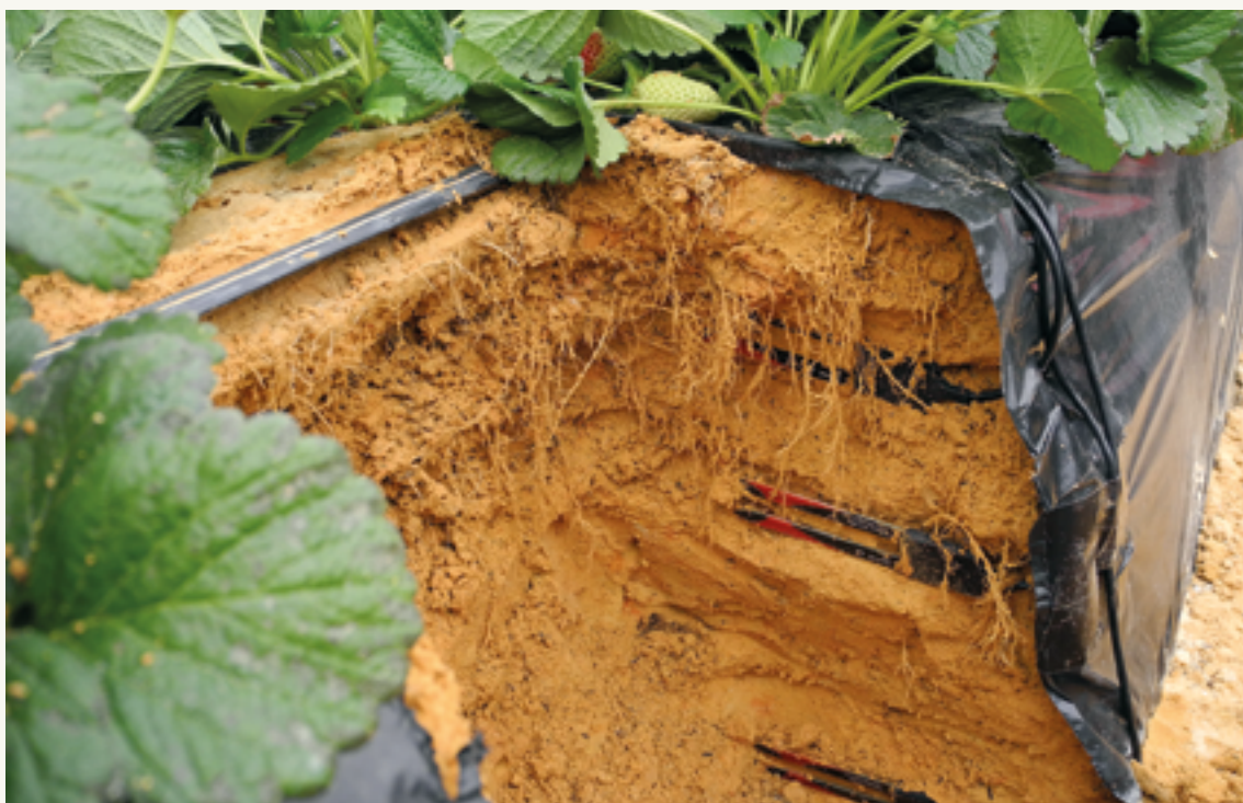
Sensores de humedad de suelo en ensayo de riego en cultivo de la fresa.
