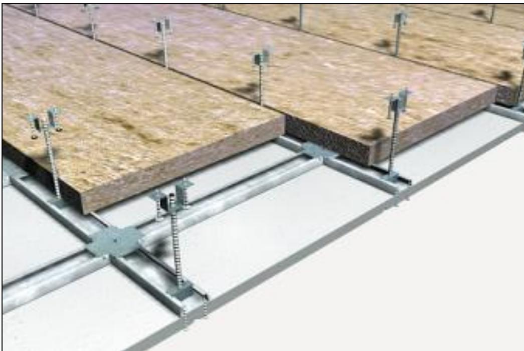
**Ilustración 18. Falso techo con aislamiento.**
