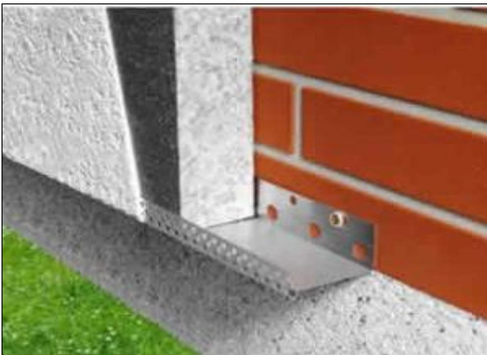
**Ilustración 16. Sección de la composición del sistema SATE.**
