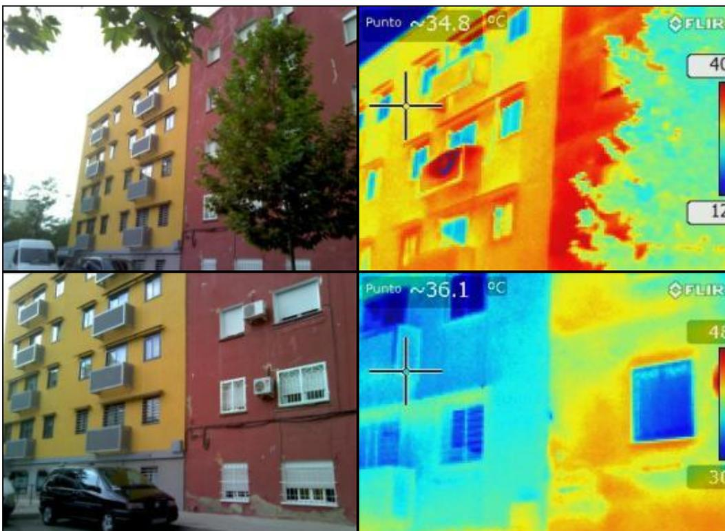
**Ilustración 13. Termografía comparación fachada aislada (a la izquierda)/fachada sin aislar (a la derecha).**
