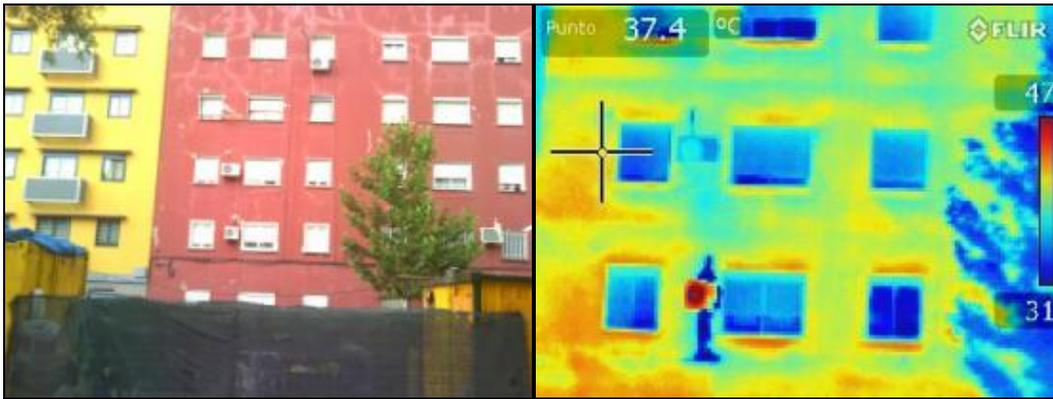
**Ilustración 12. Termografías de la fachada trasera del edificio.**
