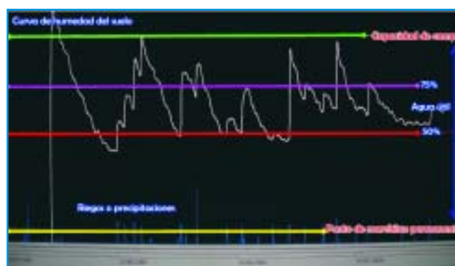
Figura 4.2. Curva de humedad
