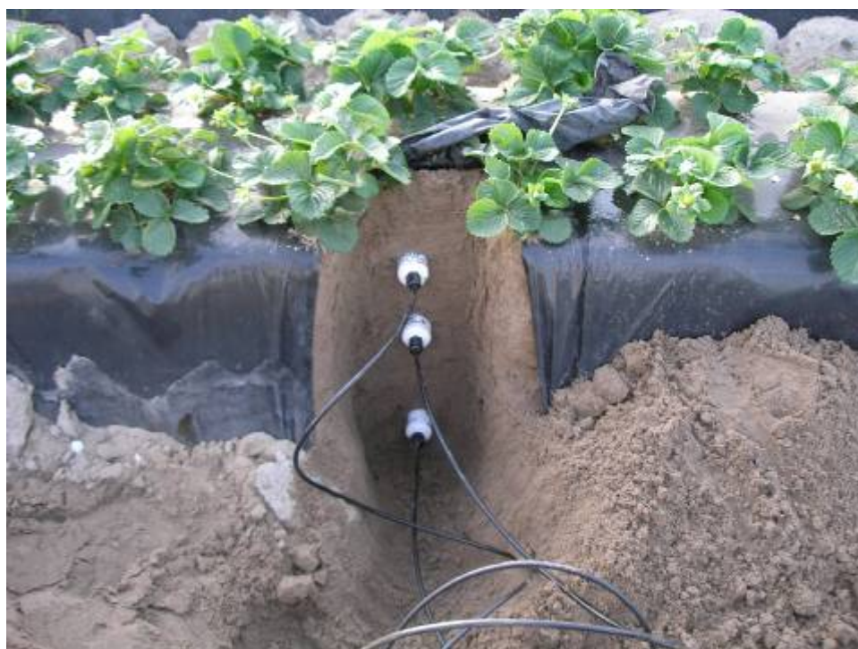
Sensor de humedad del suelo de un dispositivo de ahorro de agua
